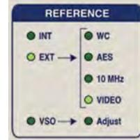
EXTERNALリファレンスは、リアパネルのユニバーサル入力コネクタ（BNC）への接続となります。入力タイプの選択により、実際の入力信号に対応します。
