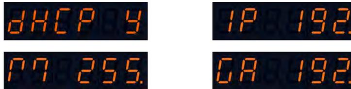
[LEFT] and [RIGHT] のナビゲーションキーを押してゆくと、下記の全体を表示します：
